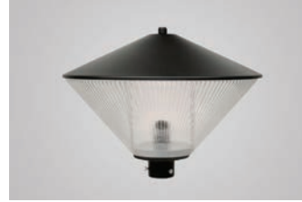
ID 502 / ID 503 Difusor cone prismático Soquete E27 / E40 - 160W Encaixe: Ø 63,5mm Base alumínio fundido Preto / Branco / Verde / Titânio 540 x 540 x 330mm
