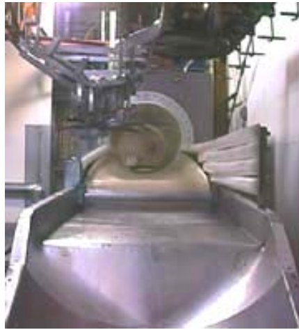
Figura 20. ToBEC, mostrando o túnel pelo qual passa a carcaça. Fonte: SiouxPreme Pork Products, 2001.
