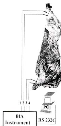
Figura 21. Instrumento para medir a impedância bioelétrica, com a colocação de quatro eletrodos. Fonte: Bohuslavek, 2001.
