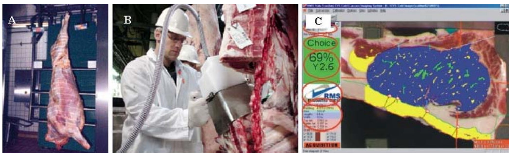
Figura 19. Análises de imagens de carcaça (A, BCC-2), e do olho do lombo e a gordura de cobertura (B e C, CVS).
